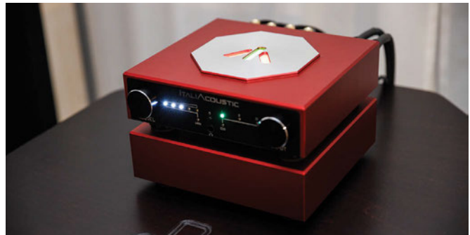
ItaliAcoustic - ItaliAcoustic utilizza una tipologia di funzionamento proprietaria per i propri amplificatori, denominata classe HS, con la quale è stato sviluppato anche l'integrato HSA-05S, operativo nella suite a pilotare una coppia di diffusori Monitor Audio Gold 100 6G. La sorgente era a scelta tra media server e CD Pro-Ject CDbox S3, connessi al DAC M2Tech Young MK4, il tutto servito da cavi Ricable serie Magnus. Interessante la lista "à la carte", che permetteva ai visitatori di scegliere quale brano ascoltare.
